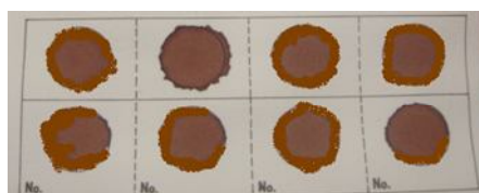
Paso 2. Muestra impregnada correctamente en los 8 círculos
