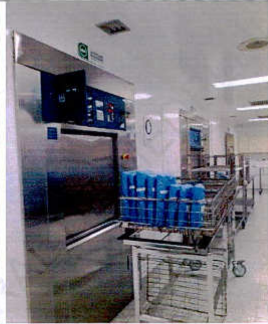
Foto 2. Auto claves vapor: alta temperatura, propiedad del Hospital
