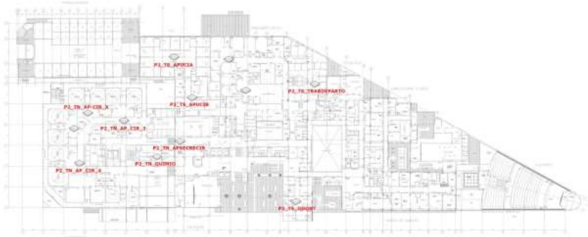
El piso 3 se instalan un total de 11 AP Aerohive, para un total de 92 ap prestando servicio wlan en el HGM.
